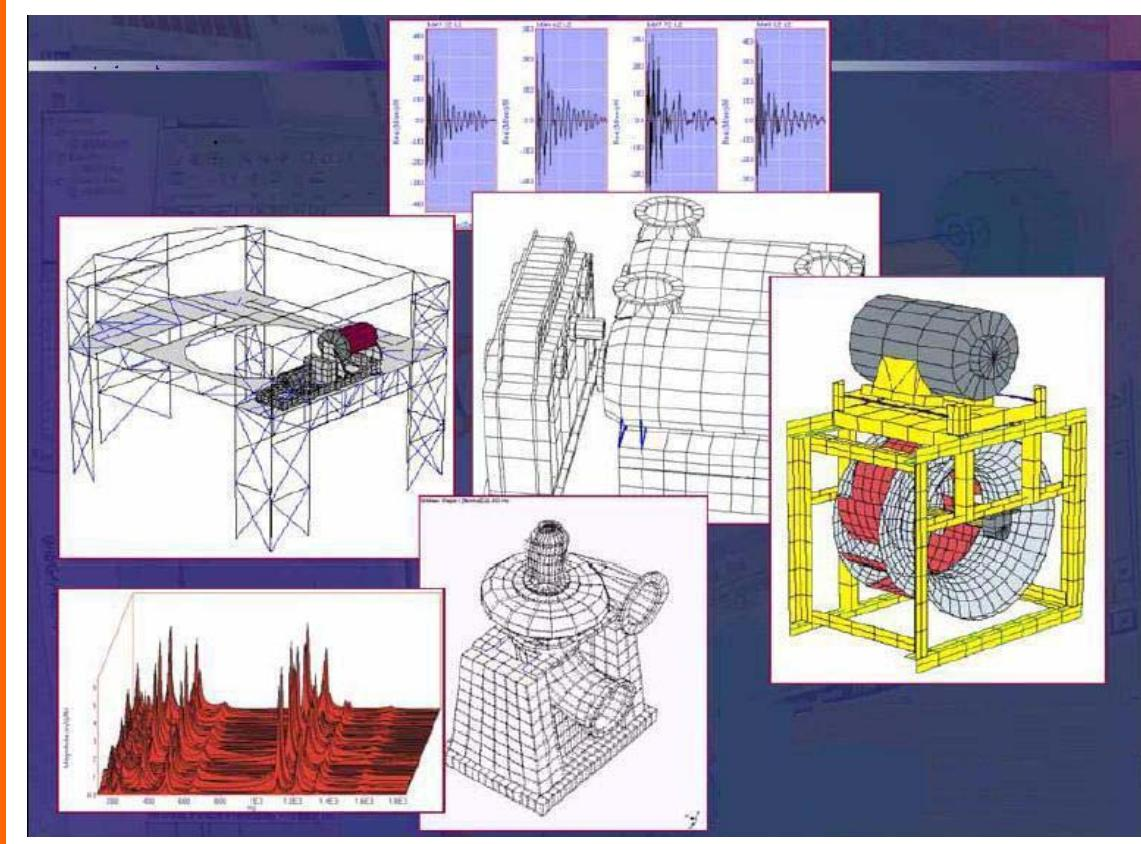
**ME'scopeVES**（可视化工程系列）作为基于测试处理和分析的软件包，可使你很容易观察和分析机械和结构的多种噪声和振动问题的根源。
